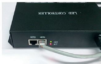
Рис. 2. Подключение контроллера HX-801RC к мастер-контроллеру или компьютеру.
